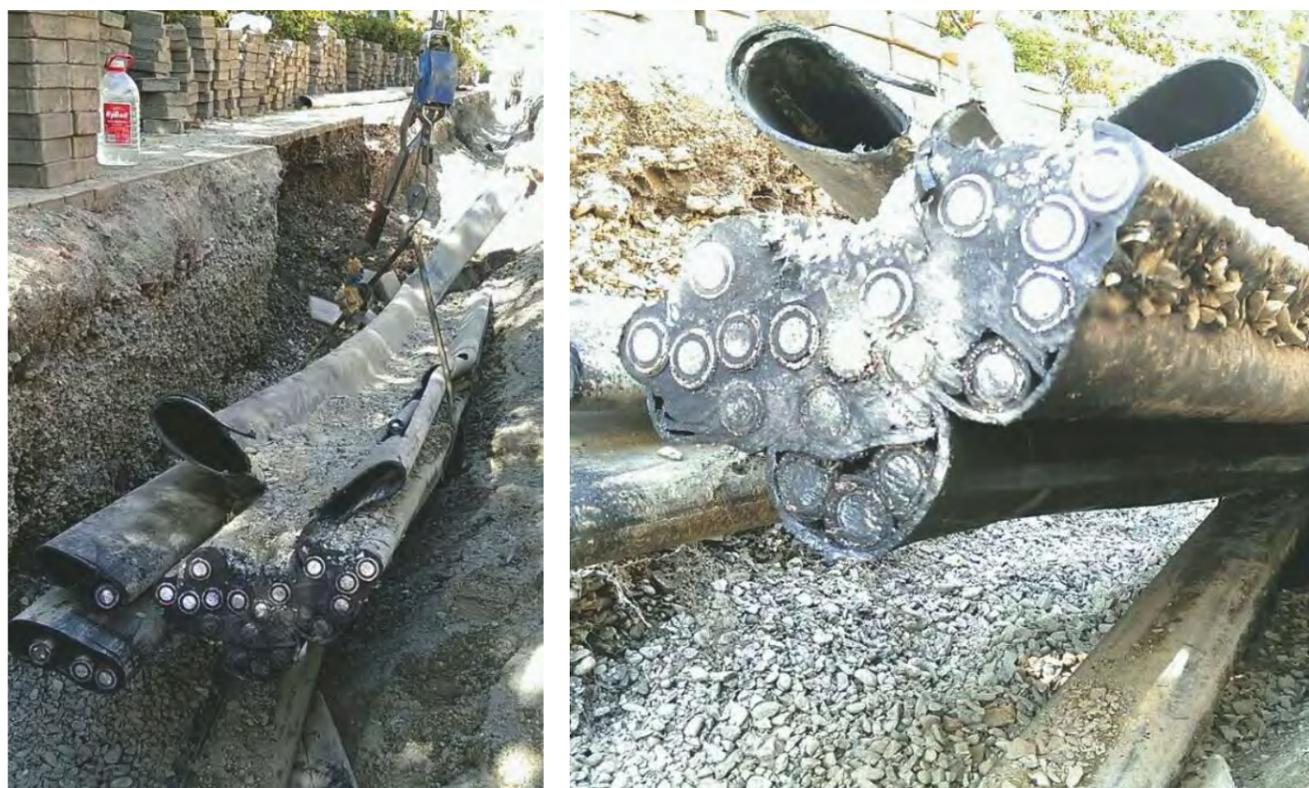
Фото 1. Деформация и слипание трубы с кабелями.
