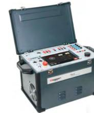
Система комплексной диагностики подстанционного оборудования
