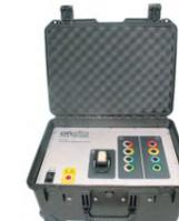
Система диагностики силовых трансформаторов с устройством РПН
