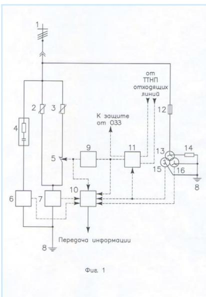
Рисунок 4 – Электрическая схема устройства безынерционного, глубокого ограничения перенапряжений
