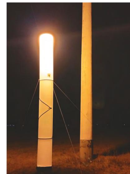
Рисунок 2. Применение осветительной установки «Световая башня» для работ в ночное время на воздушных линиях электропередачи.
