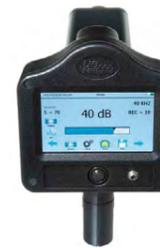
Ультразвуковая инспекционная система
