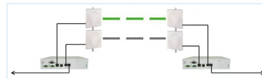
Рис. 4 Резервирование линка 1+1 на BreezeAir
