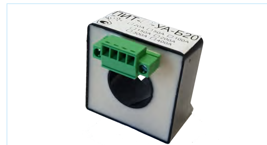
Рис 4 Модернизированный преобразователь силы тока с увеличенным до 20 мм диаметром отверстия под токовую шину и диапазоном измерений до 400А
