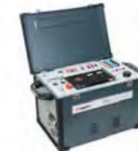
Система комплексной диагностики подстанционного оборудования
