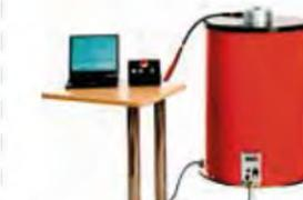
Система диагностики и локализации мест повреждений кабельных линий
