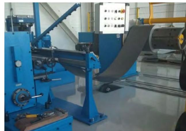
Линия продольной резки электротехнической стали (Tuboly Astrionic AG)
