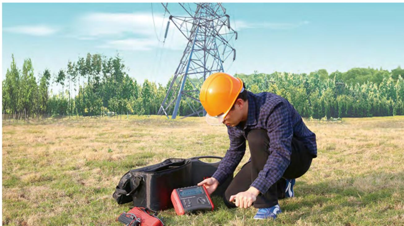
Компанией UNI-TREND выпущен новый прибор UT572, вобравший в себя лучшее из конструкций UT521 и UT522, однако обладающий более широкими возможностями. Прибор дополнительно измеряет удельное сопротивление грунта, имеет повышенный до 40 кОм предел измерения.
