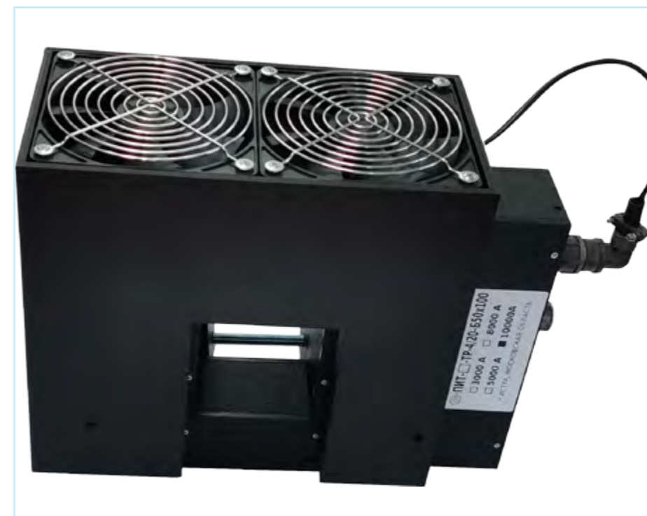
Рис. 8 - Внешний вид разъемного датчика с блоком вентиляторов для наружного охлаждения.
