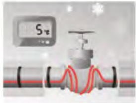
Защита труб от замерзания
