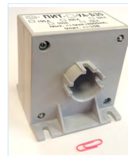
Рис. 3 - Датчик тока под шину 30мм (а) и его модернизированный вариант под 40мм (б)
